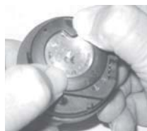
Рис.67. Установка удерживающего кольца
