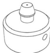
Рис 2. Фитинг для измерения от баллона.
