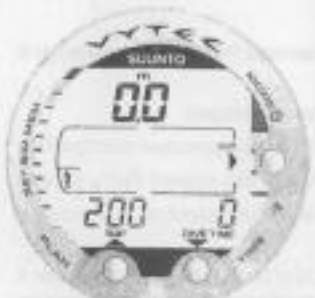
Рис. 4.18 Имитатор погружений. Для имитации погружения - нажмите кнопку TIME, для имитации всплытия - кнопку PLAN.
