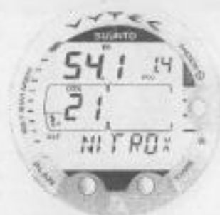
Рис. 3.21 Режим NITROX. Максимальная глубина погружения при текущих параметрах смеси (21% O 2 и 1.4 бар PO 2 ) - 54.1 м.
