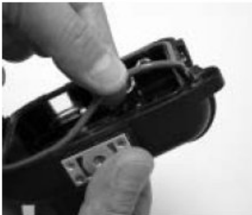
Шаг 2: Аккуратно поднимите и вытащите кольцо из канавки
