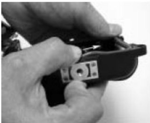
Шаг 2: Аккуратно поднимите и вытащите кольцо из канавки
